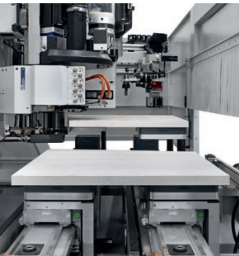
Systèmes de blocage pneumatique Uniclamp et Hyperclamp à détachement rapide pour des blocages rigides et précis.
