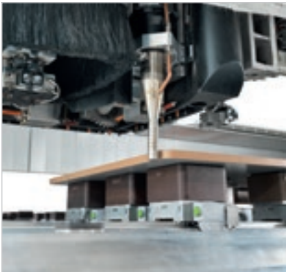
Groupe souffleur à air froid ou chaud pour raviver la couleur du chant.
