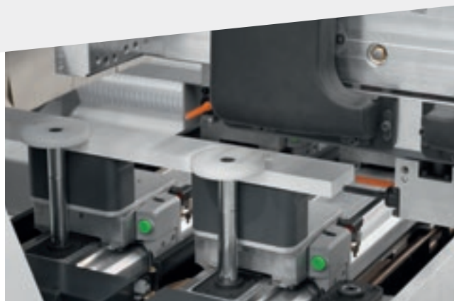
Système de blocage Easyclamp pour les façonnages de pièces étroites.
